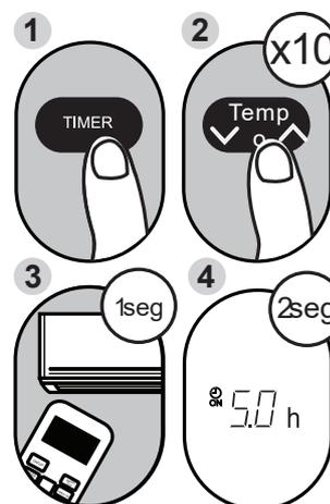
**Ejemplo:** Configurando la unidad para que se apague luego de 5 horas.
