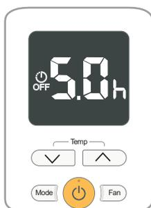
Presione los botones TEMP  $\nabla$  o  $\wedge$  hasta alcanzar la temperatura deseada.
