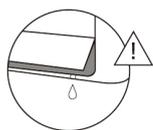
Precaución: No coloque las aletas en una posición completamente vertical por largos períodos de tiempo. Esto puede causar condensación de líquido, goteras y daño a sus muebles.
