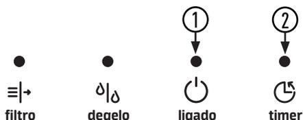
O LED indicador de funcionamento **ligado** em combinação com o LED indicador do temporizador **timer** piscam conforme a necessidade de limpeza ou substituição do filtro de ar.
