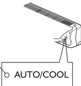
1. Abrir e levantar o painel dianteiro até ficar fixo emitindo o clique de encaixe.
