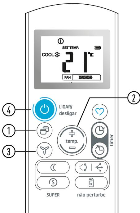
3 - Pressione a tecla de configuração da velocidade do ventilador para selecionar um dos modos indicados:
