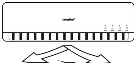
Regular **manualmente** os defletores verticais para alterar a direção do fluxo de ar para esquerda, ao centro ou para direita, movendo a(s) alavanca(s) situada(s) na extremidade esquerda (ou direita) dos defletores (esta posição poderá variar conforme o modelo).
