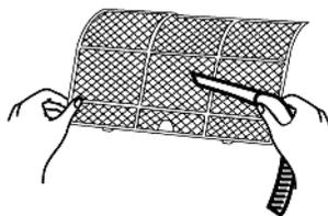
4. Reintroduzir a parte superior do filtro de ar na unidade prestando atenção que a beirada direita e externa estejam perfeitamente alinhadas; recolocar o filtro.
