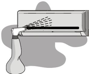
Não obstrua a descarga de ar em nenhuma das unidades, interna e externa. Esta ação bloqueará o fluxo de ar diminuindo a capacidade de resfriamento e um mau funcionamento da unidade.
