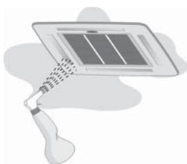
Não obstrua a descarga de ar em nenhuma das unidades, interna e externa. Esta ação bloqueará o fluxo de ar, diminuindo a capacidade de resfriamento e um mau funcionamento da unidade.
