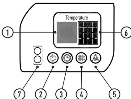
1. **Receptor de Sinais:** Sensor do controle remoto
