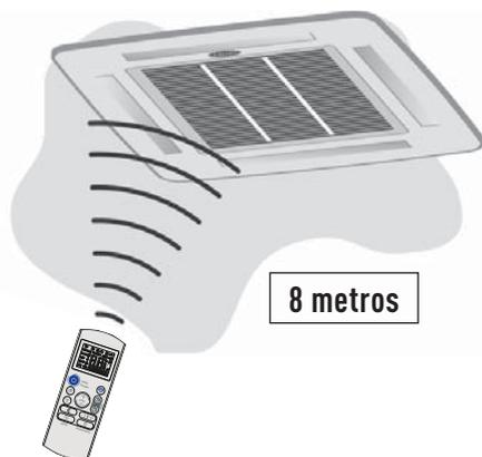
Posicionar o controle remoto de modo que os sinais enviados possam alcançar facilmente o receptor da unidade interna (a uma distância máxima de 8 metros).
