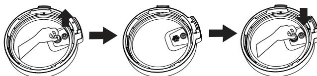
Нажмите сбоку решетки и поднимите ее, чтобы снять. Чтобы установить решетку на место, насадите ее на паровой клапан и надавите до ее фиксации.
