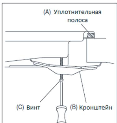
1. Поместите кронштейн (В) над отверстиями, которые соответствуют размерам винтов. В каждом углу варочной панели имеется один комплект отверстий под винты. Слегка затяните винт (С) через кронштейн (В) так, чтобы кронштейны прилегали к панели, но при этом вы могли регулировать положение.
