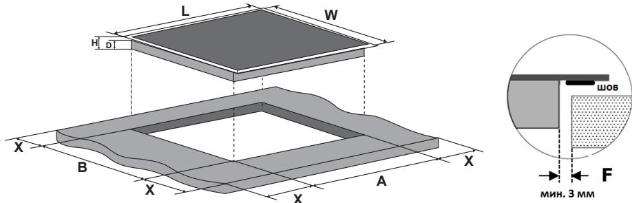
**!** Примечание: безопасное расстояние между боковыми сторонами варочной панели и внутренними поверхностями столешницы должно быть не менее 3 мм.
