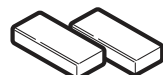
Blocs de remplissage ou morceaux de bois de rebut, si nécessaire pour l'espacement de l'armoire supérieure (utilisés uniquement sur les installations d'armoires inférieures encastrées)
