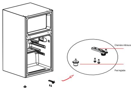
5) Remplacez l'installation de la position de la charnière inférieure et celle du pied réglable, puis fixez-les respectivement. Retirez le tuyau de manchon de charnière de la porte du frigorifique et installez-le de l'autre côté. Retirez le tuyau de manchon de charnière de la porte du congélateur et installez-le de l'autre côté.
