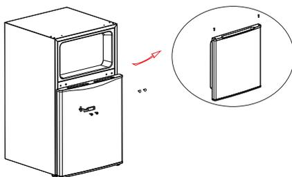
7) Placez la porte du congélateur sur la charnière centrale, puis fixez la charnière supérieure, le couvercle de la charnière supérieure du côté gauche et insérez les bouchons des trous du côté droit.
