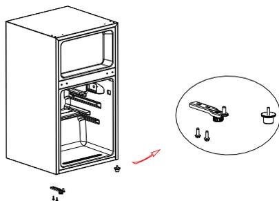
6) Placez la porte du frigorifique sur la charnière inférieure, puis fixez la charnière centrale du côté gauche et insérez les bouchons des trous du côté droit.
