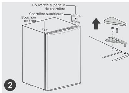
3. Démontez le couvercle de la charnière supérieure, les vis et la charnière supérieure, et retirez les bouchons en plastique des trous de vis de l'autre côté.
