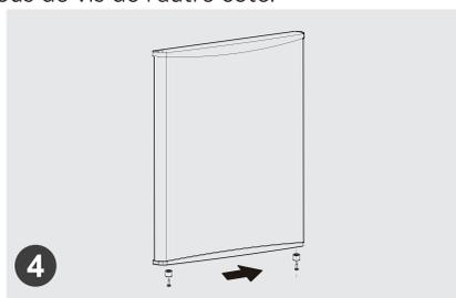
4. Démontez la porte et l'ensemble charnière inférieure et pied réglable, puis montez l'ensemble charnière inférieure et pied réglable de l'autre côté.
