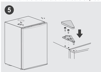
5. Démontez la butée sous la porte, puis montez la butée de l'autre côté. Placez la porte sur la charnière inférieure et montez successivement la charnière supérieure, le couvercle de la charnière supérieure et les bouchons des trous de vis en plastique.
