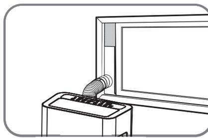
5. Insérez l'adaptateur pour glissière de fenêtre dans le trou de la glissière de fenêtre.
