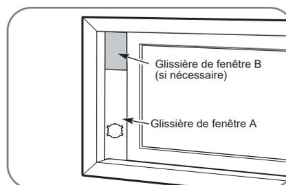
2. Insérez l'ensemble de la glissière dans l'ouverture de la fenêtre.
