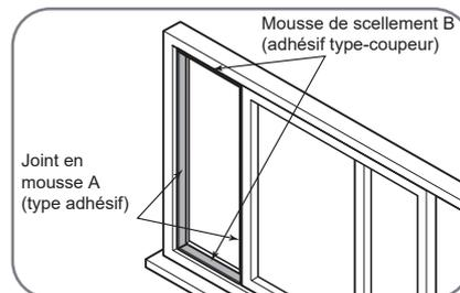
1. Coupez les bandes de mousse adhésive A et B à la bonne longueur et fixez-les sur le châssis et le cadre de la fenêtre comme indiqué.
