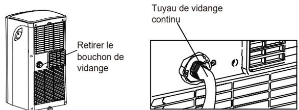
**REMARQUE:** Assurez-vous que le tuyau est bien fixé pour éviter les fuites. Dirigez le tuyau vers le drain, en vous assurant qu'il n'y a pas de coudes qui empêcheraient l'écoulement de la chaudière. Placez l'extrémité du tuyau dans le drain et assurez-vous que l'extrémité du tuyau est en bas pour permettre à l'eau de s'écouler doucement. Lorsque le tuyau de vidange continue n'est pas utilisé, assurez-vous que le bouchon et le bouton de vidange sont bien installés pour éviter les fuites.
