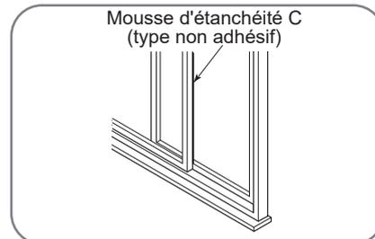
3. Coupez la bande de joint en mousse non adhésive C pour qu'elle corresponde à la largeur (ou à la hauteur) de la fenêtre. Insérez le joint entre le vitrage et le cadre de la fenêtre pour empêcher l'air et les insectes de pénétrer dans la pièce.
