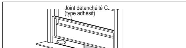
Couper le joint d'étanchéité non-adhésif C pour correspondre à la largeur de la fenêtre. Insérer le joint entre le verre et le cadre de la fenêtre pour empêcher l'air et les insectes d'entre dans la pièce.
