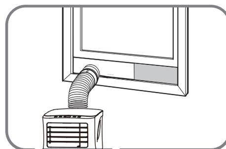
Insérer l'adaptateur pour l'ensemble glissière dans le trou de la glissière A.
