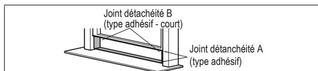
Couper les joints d'étanchéités adhésifs A et B à la bonne longueur, et affixer-les au châssis et au cadre de la fenêtre comme indiqué.
