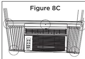
Serrez les vis de verrouillage de 1/2 pouce (12,7 mm) à travers le rail supérieur dans le châssis de la fenêtre (Figure 8B/8C).
