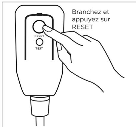
Le cordon d'alimentation contient un dispositif de courant qui détecte les dommages causés au cordon d'alimentation. Testez votre cordon d'alimentation comme suit :
