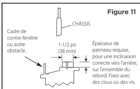
Ajoutez du bois, comme illustré à la Figure 11, ou retirez les fenêtres de protection contre l'air avant d'installer le climatiseur.
