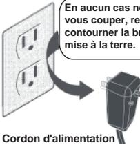
Cordon d'alimentation avec fiche de terre à trois broches et dispositifs de détection du courant.
