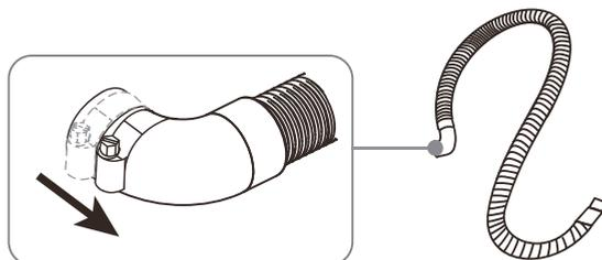
2. Insérez le tuyau de vidange avec le collier sur le tuyau d'évacuation de la laveuse. Assurez-vous que le tuyau de vidange couvre complètement l'extrémité du tuyau d'évacuation.
