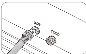
**REMARQUE :** Si vous ne souhaitez pas utiliser le tuyau d'alimentation en eau chaude, insérez un bouchon d'arrivée d'eau dans l'orifice d'arrivée d'eau chaude. Dans ce cas, vous devez sélectionner l'option « Tap Cold » (Eau froide du robinet) pour la température de l'eau.
