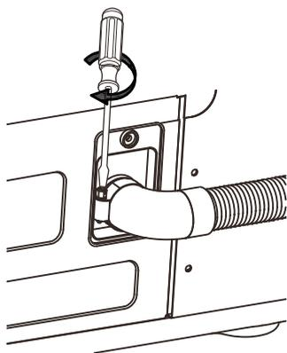
4. Fixez le tuyau de vidange à l'armature de la laveuse aux endroits indiqués à l'aide des colliers de serrage (2) fournis en utilisant un tournevis cruciforme.
