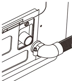
3. Déplacez le collier vers la sortie du tuyau d'évacuation. Serrez le collier à l'aide d'un tournevis plat.
