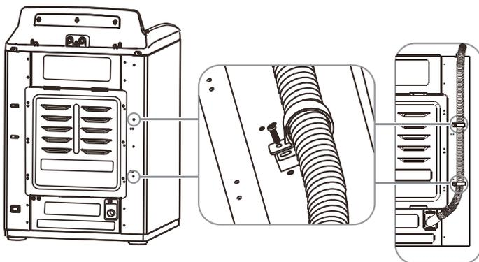
5. Insérez le tuyau de vidange avec le collier sur le tuyau d'évacuation de la laveuse. Assurez-vous que le tuyau de vidange couvre complètement l'extrémité du tuyau d'évacuation.
