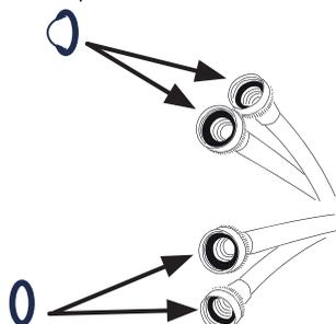
2. Serrez les raccords du tuyau et du robinet à la main jusqu'à ce qu'ils soient bien serrés, puis serrez-les de deux tiers de tours supplémentaires avec des pinces ou une clé. Tirez les tuyaux d'alimentation en eau vers le bas pour vous assurer qu'ils sont bien connectés.
