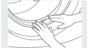
2. Tout en maintenant le joint de porte enfoncé, inspectez le joint intérieur en le tirant vers le bas avec vos doigts. Retirez tout corps étranger qui pourrait être coincé à l'intérieur du joint d'étanchéité. Assurez-vous que rien ne bloque les trous derrière le joint.
