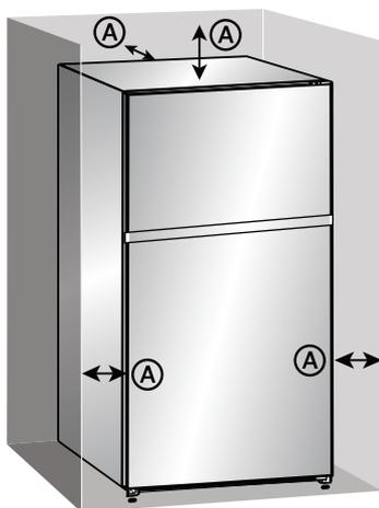
Ⓐ Dégagement de 3 po (7,6 cm) à la partie supérieure, arrière et sur les deux côtés du réfrigérateur
