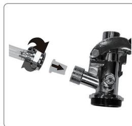
2. Poussez l'autre extrémité de la conduite de CO<sub>2</sub> à travers le trou à l'arrière de l'armoire. Faites glisser un collier de serrage sur l'extrémité de la conduite de CO<sub>2</sub>, puis fixez la conduite au raccord cannelé en bas du détendeur. Utilisez un tournevis à tête plate pour fixer la conduite de CO<sub>2</sub>.
