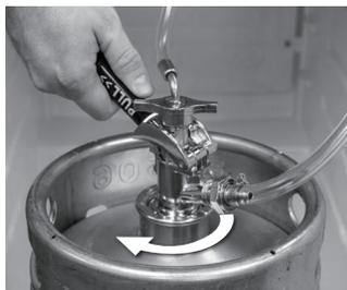
3. Assurez-vous que la tour est en position fermée (poignée vers le haut). Sécurisez la connexion en tirant sur la poignée du coupleur et en poussant vers le bas jusqu'au verrouillage complet. La poignée de tirage émet un « clic » lorsqu'elle devient dans la position finale vers le bas. Cela ouvre les robinets de bière et de gaz CO<sub>2</sub>. Le fût est maintenant mis en marche.
