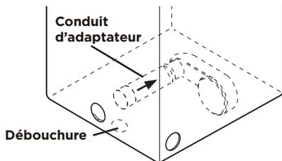
3. Insérez le coude de 10,2 cm (4 po) dans l'ouverture arrière et raccordez-le au conduit adaptateur. Assurez-vous que l'extrémité mâle du coude est orientée vers l'ouverture dans la partie inférieure de la sécheuse. Fixez le tout à l'aide de ruban en aluminium. Mettez du ruban en aluminium à l'arrière de la sécheuse.
