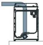
NE restreignez PAS la sécheuse en utilisant un système d'évacuation de mauvaise qualité.
