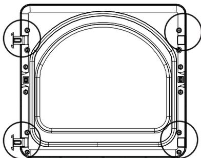
2. Utilisez un tournevis à tête plate pour ouvrir les 5 attaches et tirez sur le panneau intérieur de la porte depuis le panneau extérieur de la porte.
