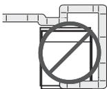
Utilisez un conduit métallique rigide de 4 po (10,2 cm) de diamètre. Scellez tous les joints, y compris au niveau de la sécheuse. N'utilisez jamais de vis qui entraînent l'accumulation de charpie.
