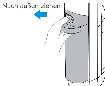
2. Halten Sie den Behälter mit einer Hand fest und ziehen Sie mit der anderen Hand die obere Abdeckung des Behälters heraus.
