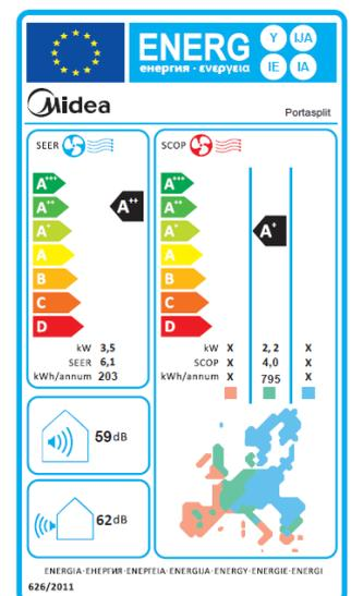
1) Die PortaSplit wurde gemäß den Standardtestbedingungen von Stiftung Warentest (Außentemperatur 30 °C/Innentemperatur 24 °C) für mobile Klimaanlage getestet. Die Testergebnisse eines Drittanbieterlabors wurden mit den Testdaten aus dem Jahr 2021 verglichen. 2) Schallpegel in 1m Abstand im Silent-Modus. Änderungen, Irrtümer und Druckfehler vorbehalten, Abbildungen ähnlich. Stand Februar 2024.
