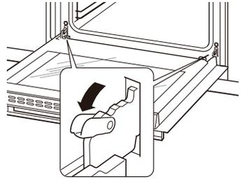
2. Schließen Sie die Tür in einem Winkel von etwa 30°. Halten Sie die Tür mit einer Hand auf jeder Seite fest. Heben Sie die Tür an und ziehen Sie sie langsam aus dem Backofen heraus.
