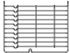
**Teleskopschiene:** Einige Modelle können mit Teleskopschienen ausgestattet sein, um die Benutzung des Ofens zu erleichtern. Diese Teleskopschienen und Gleitbügel können durch Lösen der Befestigungsschrauben demontiert werden. Nach dem Zerlegen können die Speisen und das Tablett auf den Backofenboden gestellt werden, wobei die Funktionen Strahlungsgrill, Doppelgrill, Doppelgrill mit Ventilator verwendet werden können.
