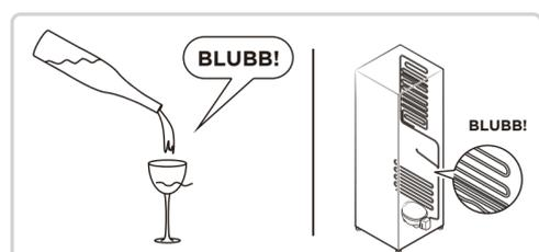
**KRACK:** Krachende Geräusche oder Geräusche von brechendem Eis: Durch die Gesamtkonstruktion des Kühlschranks kommt es zu mit Ausdehnen und Zusammenziehen von Frost im Luftkanal zu Ausdehnungsgeräuschen. Dies sind normale physikalische Phänomene.
