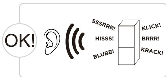
**KLICK:** Einige elektrische Teile im Kühlschrank, wie das elektrische Ventil, machen dieses Geräusch im Betrieb. Das ist normal.
