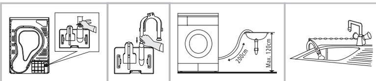
Verwenden Sie eine Zange, um den Ablaufschlauch vom externen Schlauchanschluss zu entfernen.
