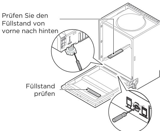
**⚠** Die maximale Einstellhöhe der Füße beträgt 50 mm.
