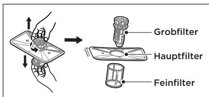
3. Größere Speisereste können durch Abspülen des Behälters unter fließendem Wasser gereinigt werden. Für eine gründlichere Reinigung verwenden Sie eine weiche Reinigungsborste.
