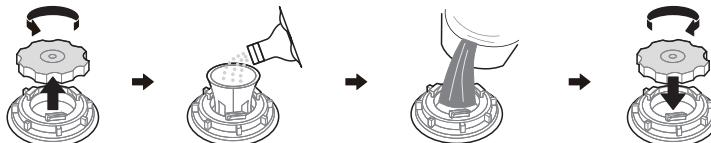
1. Retirez le panier inférieur et dévissez le bouchon du réservoir.
