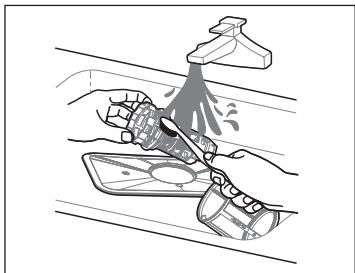
4. Remontez les filtres dans l'ordre inverse du démontage, replacez la cartouche filtrante et tournez dans le sens des aiguilles d'une montre jusqu'à la flèche de fermeture.
