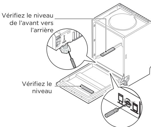
**⚠** La hauteur de réglage maximale des pieds est de 50 mm.
