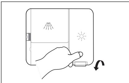
2. Versez le produit de rinçage dans le distributeur en veillant à ne pas trop remplir.
