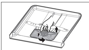
2. Der Filter kann von der Unterseite der Filtereinheit abgezogen werden. Das Grobfilter kann vom Hauptfilter abgenommen werden, indem Sie die Laschen oben leicht zusammendrücken und es abziehen.
