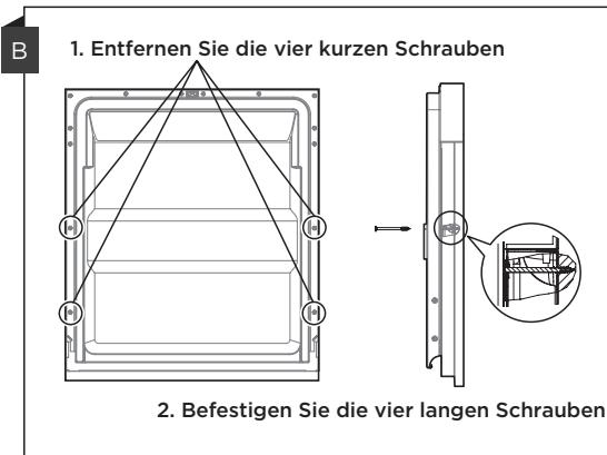
1. Entfernen Sie die vier kurzen Schrauben
