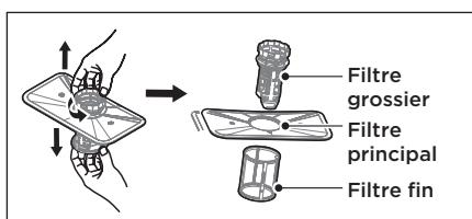
3. Les plus gros restes d'aliments peuvent être nettoyés en rinçant le filtre à l'eau courante. Pour un nettoyage plus approfondi, utilisez une brosse de nettoyage douce.
