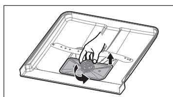
2. Le filtre fin peut être retiré de la partie inférieure de l'ensemble du filtre. Le filtre grossier peut être détaché du filtre principal en pressant doucement les languettes situées en haut et en le tirant.
