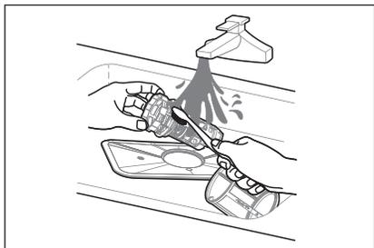
4. Remontez les filtres dans l'ordre inverse du démontage, replacez la cartouche filtrante et tournez dans le sens des aiguilles d'une montre jusqu'à la flèche de fermeture.
