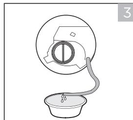
Une fois que l'eau s'est écoulée, remettez le tuyau de drainage en place.
