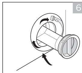
Réinsérez soigneusement le filtre et vissez le couvercle inférieur dans le sens des aiguilles d'une montre.
