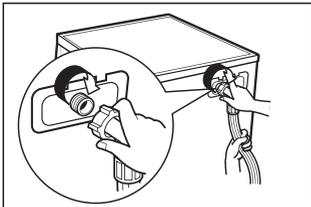
Connectez le tuyau d'alimentation en eau à la vanne d'entrée d'eau et à un robinet d'eau froide comme indiqué.
