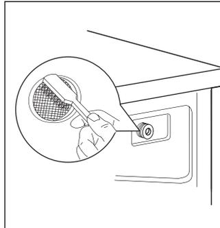
5. Réinstallez le filtre sur l'entrée d'eau et rebranchez le tuyau d'alimentation en eau.
