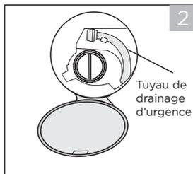
Tirez sur le tuyau de drainage d'urgence et enlevez le bouchon du tuyau.
