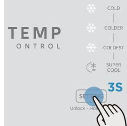
Appuyez et maintenez enfoncé pendant 3 secondes pour déverrouiller, la LED clignote pour indiquer que le déverrouillage est réussi, et le verrou est automatiquement verrouillé après 15 secondes sans qu'on ait besoin d'appuyer sur le bouton.
