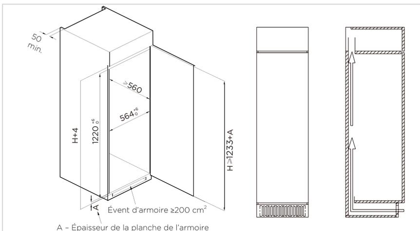
2. Poussez le réfrigérateur dans l'armoire et l'ajuster pour que la lame supérieure touche complètement le bord supérieur de l'armoire et que le crochet de limite du pied touche complètement le bord inférieur de l'armoire.
