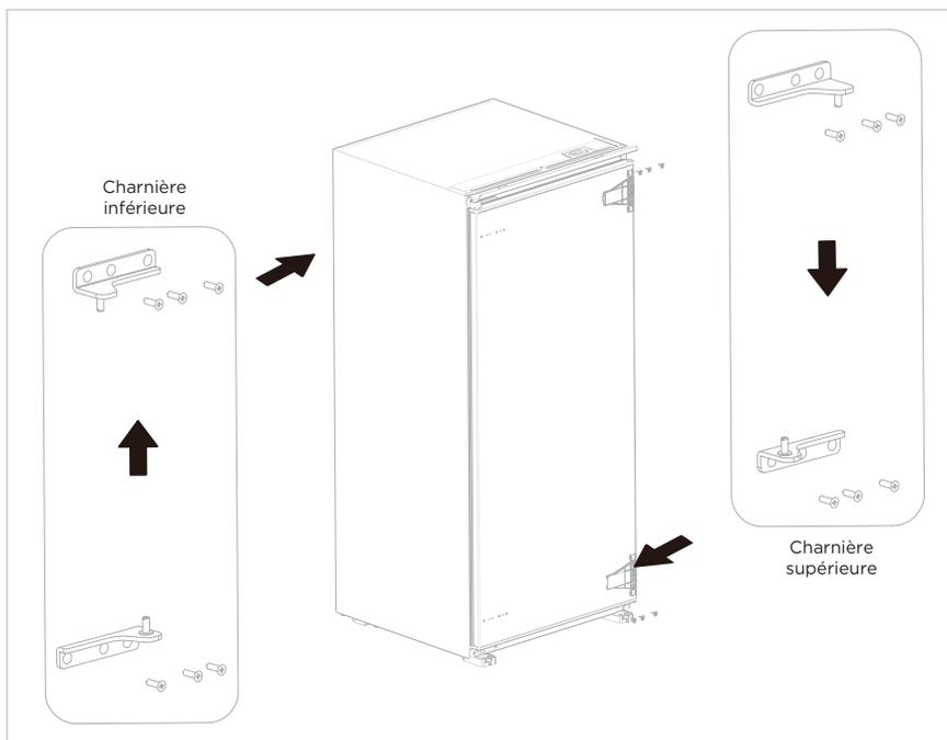
5. Retirez les deux blocs fixes de la porte du réfrigérateur et les faire pivoter de 180 °, puis les installer de l'autre côté du frigo.
