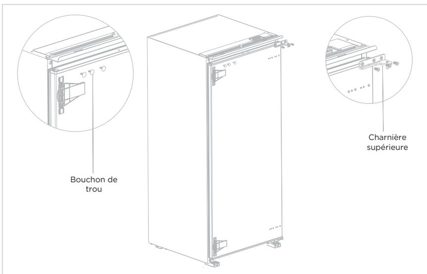
3. Retirez la porte du réfrigérateur, la charnière inférieure et les bouchons de trous.
