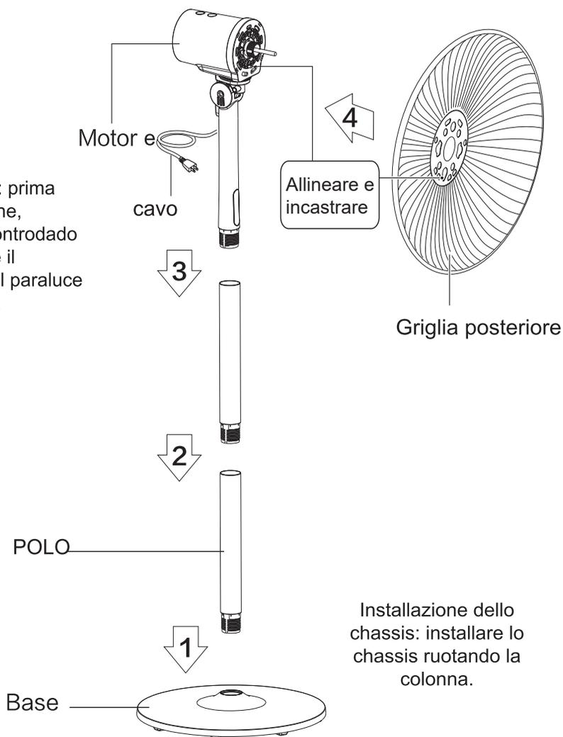
Installazione dello chassis: installare lo chassis ruotando la colonna.
