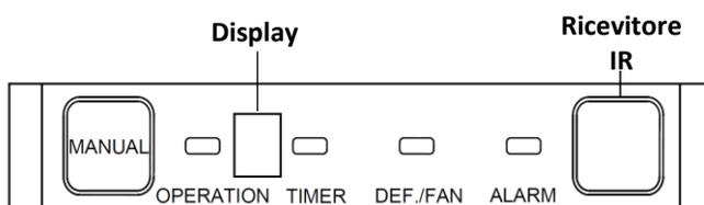
La segnalazione di codici guasto può avvenire anche mediante il display del comando a filo, con indicazione del codice nel riquadro dove è normalmente visualizzata la temperatura selezionata (Esempio codice guasto E8).
