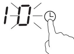
3. Configure el tiempo tocando el control deslizador. (por ejemplo, 5)
