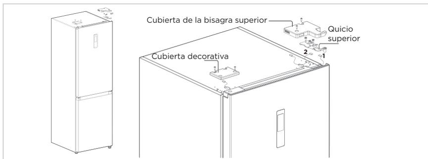
3. Retire la carcasa de la puerta del frigorífico (tenga cuidado con no perder las piezas pequeñas como el eje del manguito y el freno de la puerta). Retire el quicio medio y la cubierta decorativa del orificio del quicio del extremo contrario.
