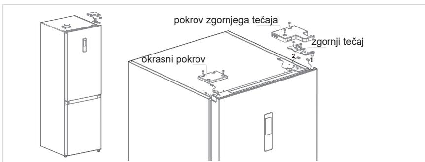
3. Odstranite ohišje hladilnih vrat (pazite, da ne izgubite majhnih delov, kot so objemka in ustavljača na vratih); Odstranite srednji tečaj in odstranite okrasni pokrov luknje za tečaj na drugi strani.
