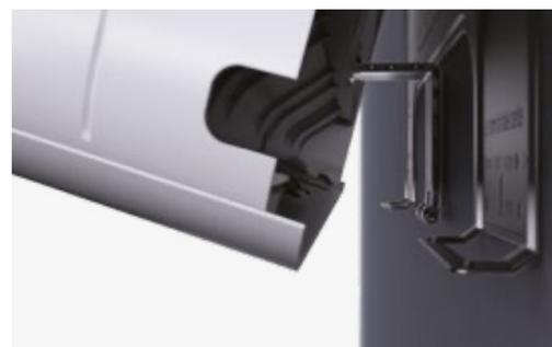
L'**installazione** dell'unità interna della gamma All Easy Pro è **semplice e rapida** grazie alla piastra di installazione con le guide per il posizionamento dello split, alla livella integrata, alla scocca inferiore asportabile per accedere comodamente alle tubazioni, al supporto per mantenere l'unità inclinata durante il montaggio e alla morsettiera ad accesso facilitato.
