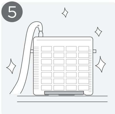
La parte anteriore dell'unità deve scivolare nella fessura corrispondente nella staffa, che le impedisce di sollevarsi. Verificare che sia salda in posizione cercando di spostarla con delicatezza. Ora è possibile rimuovere il cavo in acciaio dalla staffa.
