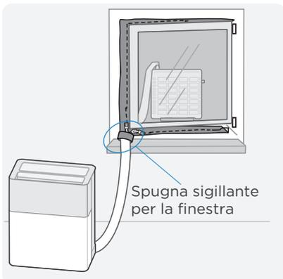
Esempio di installazione della tela di isolamento con la spugna sigillante avvolta attorno al tubo.
