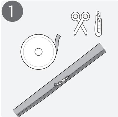
Per installare il nastro a strappo, occorrono le forbici. Disinstallare il dispositivo esterno, se installato. La staffa invece può rimanere in sede.
