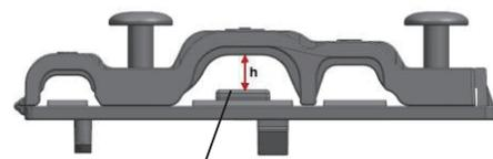
Cuando el cable no esté lo suficientemente sujeto, utilice la hebilla para sostenerlo y poder sujetarlo con firmeza.
