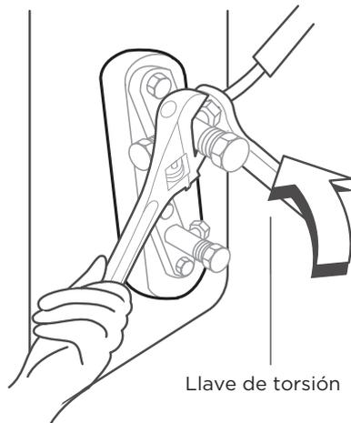
5. Mientras sujete firmemente el cuerpo de la válvula, utilice una llave dinamométrica para apretar la tuerca cónica de acuerdo con los valores de par de apriete correctos.
