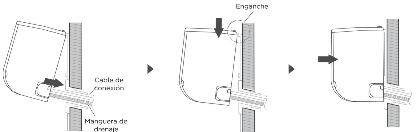
Coloque las tuberías en los orificios de la pared
