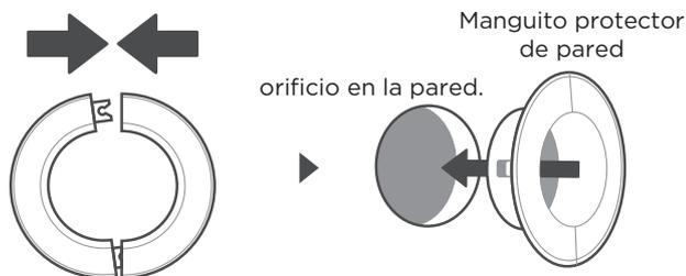
Coloque el manguito protector de pared en el orificio.
