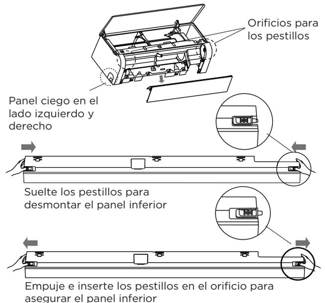
2. Si el orificio en la pared está detrás de la unidad, mantenga el panel ciego en su lugar. Si el orificio en la pared está al lado de la unidad interior, retire el panel ciego de plástico de ese lado de la unidad. Utilice unas tijeras o alicates si el panel de plástico es demasiado difícil de retirar con la mano.
