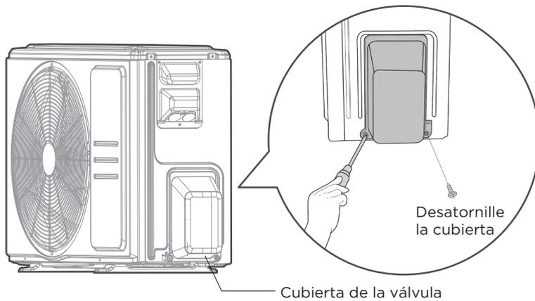
1. Desenrosque la tapa de la válvula empaquetada en el lado lateral de la unidad exterior.
