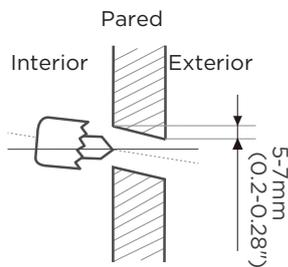
Perforación del orificio en la pared
