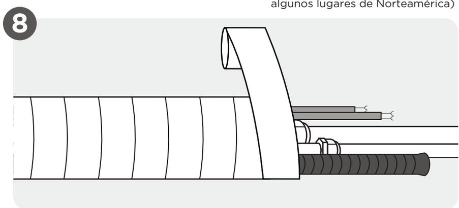
Envuelva la tubería y los cables
