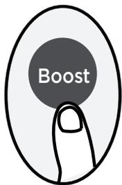
Cuando seleccione la función Boost en el modo COOL(FRÍO), la unidad impulsará aire frío con el ajuste de aire más fuerte para poner en marcha el proceso de enfriamiento.
