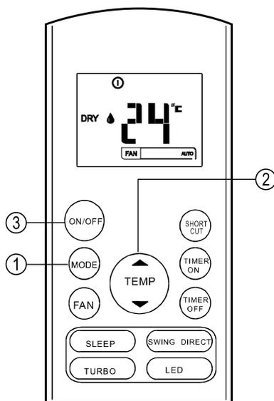
**Nota:** En el modo DESHUMIDIFICAR (DRY) usted no podrá modificar la velocidad del ventilador ya que está siendo controlada automáticamente por el aparato.
