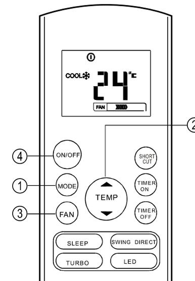
**Nota:** En el modo VENTILADOR (FAN) la pantalla del control remoto no muestra ninguna temperatura programada, y usted no podrá controlar la temperatura de la habitación. En este caso, solamente pueden seguirse los pasos 1, 3 y 4.
