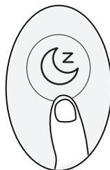
La función SLEEP(SUEÑO) se utiliza para disminuir la energía mientras duerme (y no necesitas los mismos ajustes de temperatura para mantenerse cómodo).
