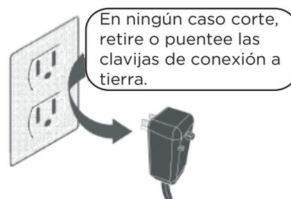
Cable de alimentación con enchufe de conexión a tierra de 3 clavijas y dispositivo de detección de corriente.
