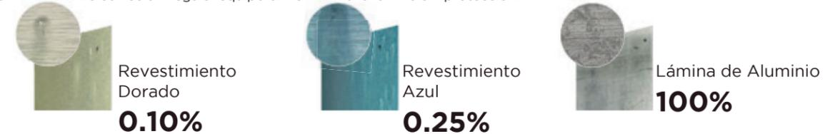
\*Tras 240 horas de prueba UV y 72 horas de prueba de niebla salina neutra.
