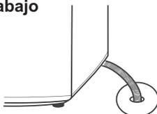
El agua puede desbordarse si la altura de la manguera de salida de agua es menor a 750mm.
