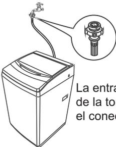
La entrada de agua consta de la toma de conexión y el conector rápido.
