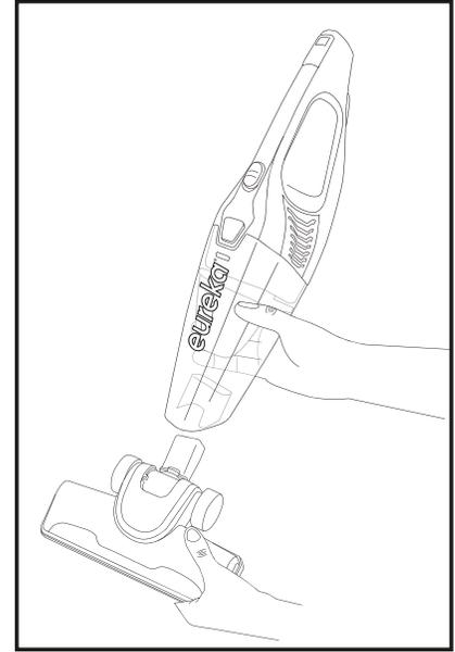
Fije el Adaptador para piso insertándolo en la abertura en la parte inferior del recipiente de polvo. Presione firmemente para asegurarla en su sitio.
