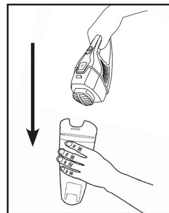
Reemplace el filtro. Coloque el contenedor de polvo en la aspiradora. Asegúrese que esté correctamente colocado.
