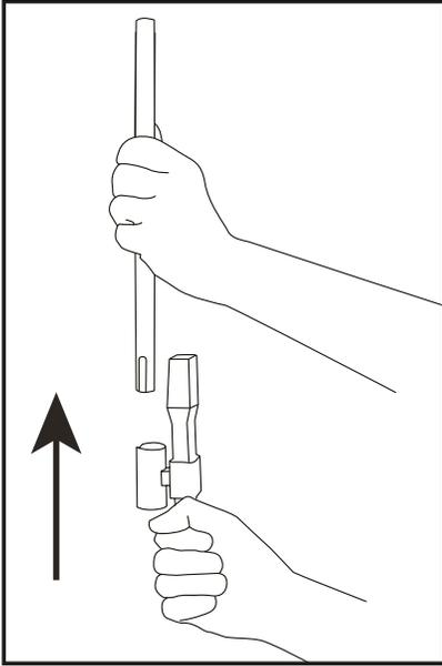
Adjunte el adaptador angosto y el soporte deslizándolo sobre el mango.
