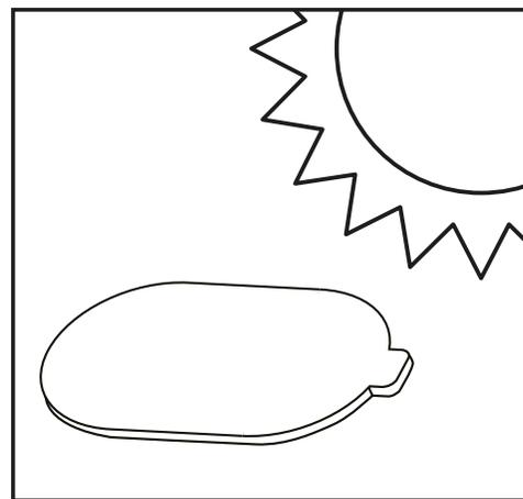
Seque al aire el Filtro pre-motor durante 24 hrs. antes de colocarlo de nuevo en la aspiradora.
