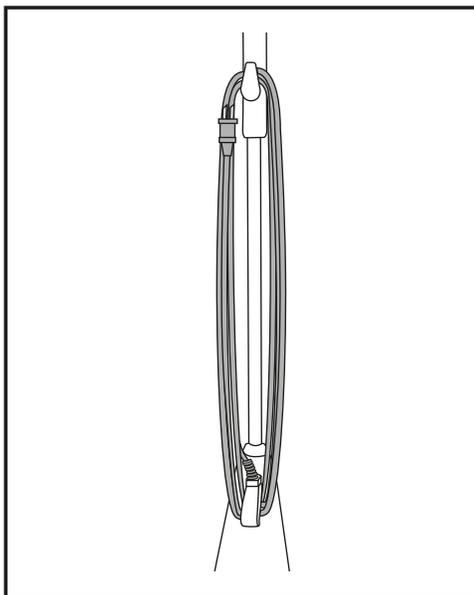
Envuelva el cable alrededor de la parte superior e inferior el cable se enrolla en la parte posterior de la aspiradora. Sujete el enchufe al cable.
