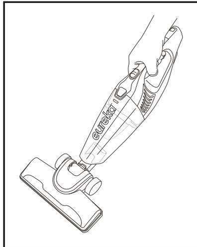
El adaptador para piso se puede usar con la aspiradora de mano para limpiar superficies más anchas. Para fijar el adaptador a la aspiradora de mano, insértelo en la abertura en la parte inferior de la aspiradora. Presione firmemente para asegurarla en su lugar.
