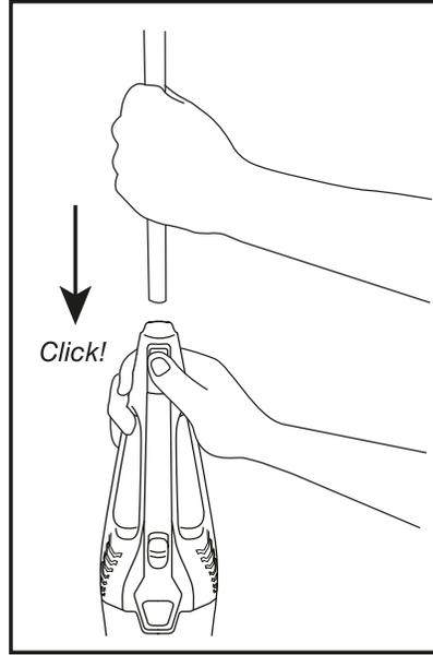
Presione el botón de liberación rápida de la aspiradora de mano e inserte el mango. Asegúrese de que esté completamente insertado en el cuerpo de la aspiradora.
