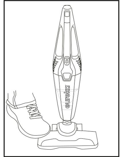
Presione el adaptador para piso e incline la aspiradora para liberar de su posición vertical.
