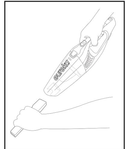
Insertar el Adaptador angosto para extender la longitud y alcance de la aspiradora.
