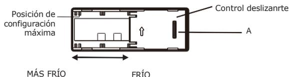
La temperatura dentro del congelador se puede ajustar cambiando la posición del control deslizante del regulador. La posición inicial del control deslizante del regulador es la posición A. Si desea una temperatura más baja dentro del congelador, ajuste el control deslizante del regulador desde la posición A hacia la izquierda. Para un mejor uso del refrigerador, mantenga la el control deslizante en la posición inicial.
