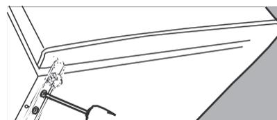
7) Compruebe que la puerta esté alineada horizontal y verticalmente y que las juntas estén cerradas en todos los lados antes de apretar finalmente la bisagra inferior. Reajuste los pies de nivelación.
