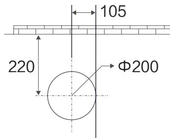
Gambarajah skema untuk saiz lubang paip ekzos pada siling
