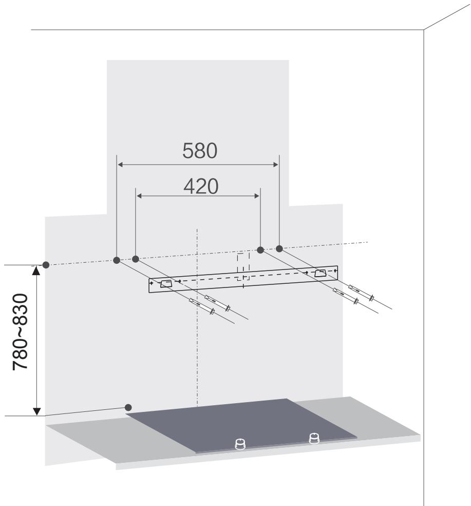
Selepas hud digantungkan pada plat pemasangan, ketatkannya dengan dua batang skru M5X50 bagi mengelakkan hud daripada tergelongsor secara tidak sengaja.
