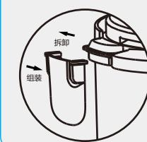
注意：请在操作电压力锅前按照“水箱修理和拆卸插图”在正确位置修理水箱。要防止出现异味，每次使用后请取出水箱进行清洁。
