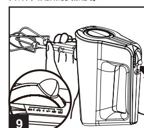
将搅拌机左侧抬起，然后将旋转开关推至“0”和/或“E”位置，弹出所有附件。
