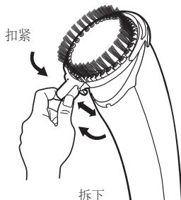
将毛刷上端扣合于烫头上边缘，烫头对正毛刷下边缘凸台后扣紧。
