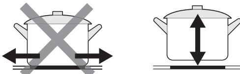
Зоны нагрева в определенной степени автоматически адаптируются к диаметру посуды. Однако для каждой зоны нагрева дно посуды должно иметь определенный минимальный диаметр. Если диаметр посуды меньше 140 мм, панель может не распознать ее.
