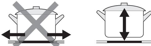
Зоны нагрева в определенной степени автоматически адаптируются к диаметру посуды. Однако для каждой зоны нагрева дно посуды должно иметь определенный минимальный диаметр. Если диаметр посуды меньше 140 мм, панель может не распознать ее.
